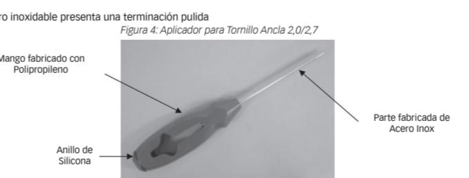
La parte fabricada de acero inoxidable constituye de un tubo con una longitud total de 185 mm (+-1), y un diámetro externo de 3,26 mm. En una de las extremidades, el tubo presenta un hexagonal para encajar el Tornillo Ancla Ø 2,0 o Ø 2,7. El Hilo de Sutura Blanco/Azul, sujetado al Tornillo Ancla Ø 2,0 o Ø 2,7, pasa por dentro del tubo.
